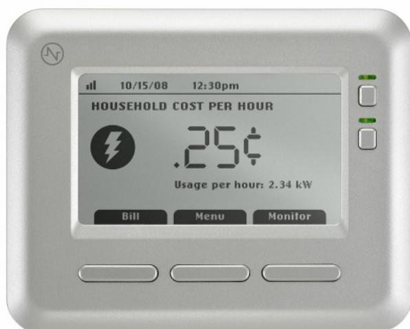
Figura 4 – Parece um termostato – mas não é. Este é o “Insite” display de gestão de energia ligado via ZigBee. Photo courtesy of Tendril Networks, Inc.
